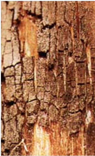
Bild 6.3.7.: Moderfäulepilze, anfangs weißlich graues, kurzes, fast krümeliges Oberflächenmyze
